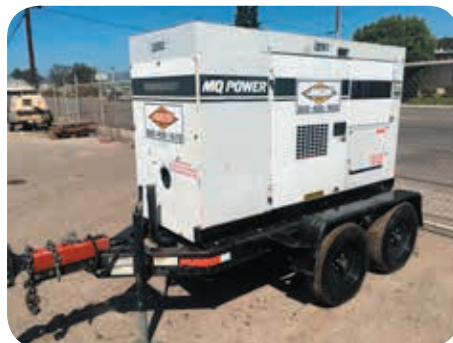
MultiQUIP 70KVA Generator
